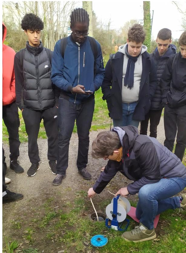
**Mesure profondeur nappe par sonde piézoélectrique**
